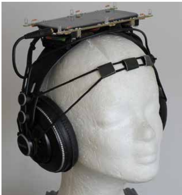
Abbildung 2: Head Mounted Device: Auf dem Bügel zwischen den Ohrmuscheln sind ein Smartphone und sechs Infrarot-LEDs angebracht. Der Kopfhörer ist ans Smartphone angeschlossen.
